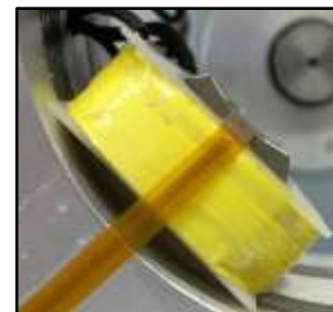
Bi Hall sensor fixed to the AMB stator pole
